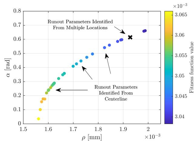
**Fig. 15** Runout parameter optimization results
